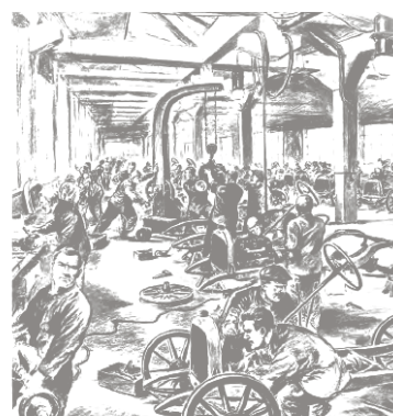
Opel-Produktion kurz nach der Jahrhundertwende. Bereits Serienbau – etwa 10 Wagen pro Tag – aber noch weit entfernt von Fließbandarbeit. Der Automobilbau war körperlich Schwerarbeit, einen organisierten Materialzufuß gab es damals nicht; die Teile wurden einzeln von Hand an das Produkt gebracht. Auch die selbsttragende Ganzstahl-Karosserie konnte man noch nicht; vielmehr wurde die Karosserie auf das Chassis und alle tragenden Teile aufgesetzt. Niet- und Schraubverbindungen waren dabei vorherrschend, Löt- und Schweißnähte gab es kaum. (Zeichnung aus dem 1937 erschienenen Heinrich-Hauser-Buch „OPEL – ein deutsches Tor zur Welt“.)
